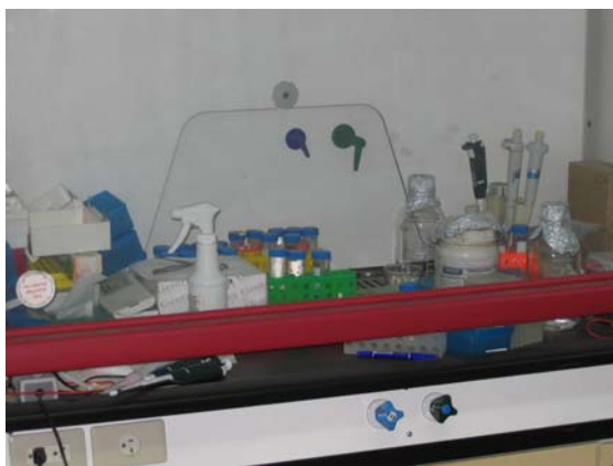
圖五 通風櫥中雜物堆積。
